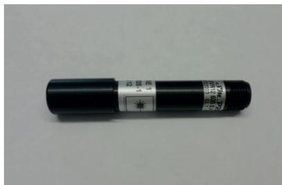
Puntatore laser costituito da un diodo laser a luce rossa di elevata qualità, disponibile nella lunghezza d'onda di 635 nm e con una potenza di 0.4mW. La ghiera permette una facile regolazione del fuoco.
