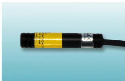
Puntatore laser costituito da un diodo laser a luce rossa disponibile nella lunghezza d'onda di 635 nm e con una potenza di 3mW. Custodia compatta, diametro 12mm e solo 65mm di lunghezza, con ampio range di alimentazione, che genera una croce molto grande. La parte anteriore filettata rende il montaggio molto veloce con 2 dadi M12x1 mm.
