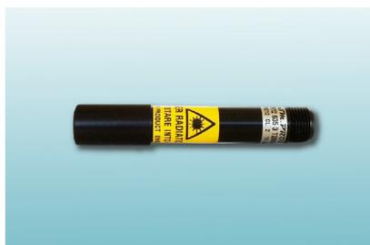
Puntatore laser costituito da un diodo laser a luce rossa di elevata qualità, disponibile nella lunghezza d'onda di 635 nm e con una potenza di 0.4mW. La regolazione del fuoco permette di ottenere un punto ben focalizzato fino ad un'altezza massima di 1 m dal piano di lavoro. Inoltre rientrando nella classe di sicurezza 1, anche la visione diretta del fascio non crea alcun danno all'occhio umano.
