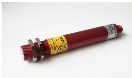
Puntatore laser costituito da un diodo laser a luce verde di elevata qualità, disponibile nella lunghezza d'onda di 532 nm e con una potenza di 1mW. Il diodo genera un punto, una linea oppure una croce. A richiesta si possono avere modelli con lunghezze di linea specifiche. La custodia parzialmente filettata M18x1 e i dadi a corredo consentono un fissaggio più facile e veloce del puntatore.
