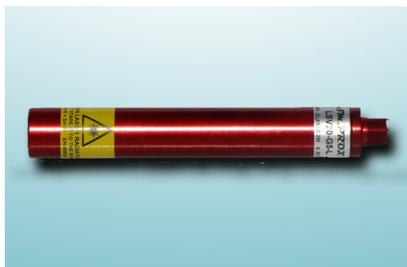
Puntatore laser costituito da un diodo laser a luce rossa di elevata qualità, disponibile nella lunghezza d'onda di 635 nm e con una potenza di 20mW. Il diodo genera un punto. A richiesta si possono avere modelli con lunghezze di linea specifiche e altre potenze. La custodia in alluminio anodizzato e il vetro di protezione permettono al puntatore di lavorare in ambienti con presenza di acqua o ambienti gravosi.
