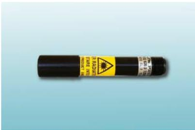
Puntatore laser costituito da un diodo laser a luce verde di elevata qualità, disponibile nella lunghezza d'onda di 520 nm e con una potenza di 3mW. La ghiera permette una facile regolazione del fuoco.
