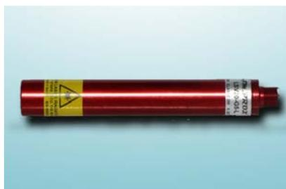
Puntatore laser costituito da un diodo laser a luce rossa di elevata qualità, disponibile nella lunghezza d'onda di 635 nm e con una potenza di 5mW, che genera un punto, una linea oppure una croce. A richiesta si possono avere modelli con lunghezze di linea specifiche. La custodia in alluminio anodizzato e il vetro di protezione permettono al puntatore di lavorare in ambienti con presenza di acqua o ambienti gravosi. A richiesta alimentazione 12...48 Vdc / 6...24 Vac.
