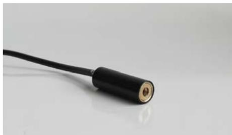
Puntatore laser costituito da un diodo laser a luce rossa di elevata qualità, disponibile nella lunghezza d'onda di 635 nm e con una potenza di 3,5mW, per puntamenti fino ad una distanza max. di 1 m.
