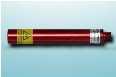
Puntatore laser costituito da un diodo laser a luce verde di elevata qualità, disponibile nella lunghezza d'onda di 520 nm e con una potenza di 20mW. Il diodo genera una linea. La custodia in alluminio anodizzato e il vetro di protezione permettono al puntatore di lavorare in ambienti con presenza di acqua o ambienti gravosi. Il nuovo diodo a 520nm permette di avere un range più ampio di temperatura (-10...+50°C) e maggiore stabilità.
