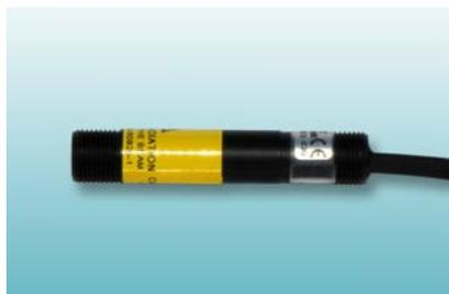
Versione economica dei puntatori laser della serie LSV12 costituiti da un diodo laser a luce rossa, disponibile nella lunghezza d'onda di 650 nm e con una potenza di 1mW. Adatto per puntamenti fino ad una distanza max. di 1 m.
