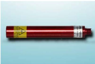
Puntatore laser costituito da un diodo laser a luce rossa di elevata qualità, disponibile nella lunghezza d'onda di 635 nm e con una potenza di 15mW, che genera un punto, una linea oppure una croce. A richiesta si possono avere modelli con lunghezze di linea specifiche e altre potenze. La custodia in alluminio anodizzato e il vetro di protezione permettono al puntatore di lavorare in ambienti con presenza di acqua o ambienti gravosi. A richiesta alimentazione 12...48 Vdc / 6...24 Vac.
