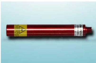
Puntatore laser costituito da un diodo laser a luce verde di elevata qualità, disponibile nella lunghezza d'onda di 520 nm e con una potenza di 10mW. Il diodo genera un punto, una linea oppure una croce. La custodia in alluminio anodizzato e il vetro di protezione permettono al puntatore di lavorare in ambienti con presenza di acqua o ambienti gravosi. Il nuovo diodo a 520nm permette di avere un range più ampio di temperatura (-10...+50°C) e maggiore stabilità.
