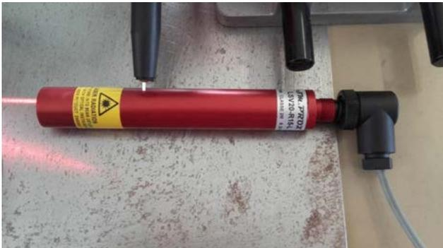
I puntatori laser Sm.Prox sono sempre più protetti dalle cariche elettrostatiche e dai disturbi infatti i nuovi puntatori hanno protezioni specifiche sul diodo laser.
