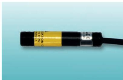
Puntatore laser costituito da un diodo laser a luce rossa di elevata qualità, disponibile nella lunghezza d'onda di 635 nm e con una potenza di 3mW. Questo puntatore è nato per avere una linea molto sottile < 1,5 mm adatto per allineamenti di precisione.
