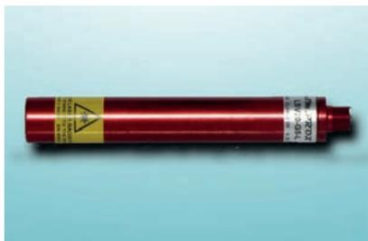
Puntatore laser costituito da un diodo laser a luce rossa di elevata qualità, disponibile nella lunghezza d'onda di 635 nm e con una potenza di 20mW. Il diodo genera un punto, una linea oppure una croce. A richiesta si possono avere modelli con lunghezze di linea specifiche e altre potenze. La custodia in alluminio anodizzato e il vetro di protezione permettono al puntatore di lavorare in ambienti con presenza di acqua o ambienti gravosi.
