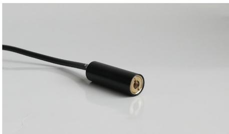
Puntatore laser costituito da un diodo laser a luce rossa di elevata qualità, disponibile nella lunghezza d'onda di 635 nm e con una potenza di 1mW, per puntamenti fino ad una distanza max. di 1 m.
